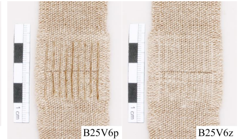
BEVA 371 Film® o tloušťce 25 µm
