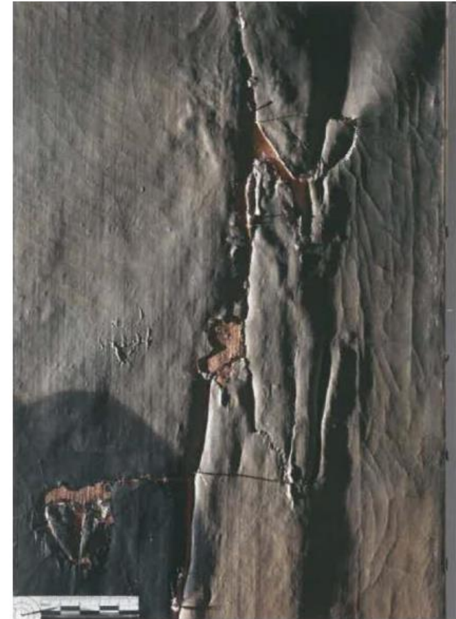
Záplata lepená glutinovým adhezivem, silné deformace. In: HARTWICH, Claudia, PLÖTZ, Sandra 2016, s. 326.
