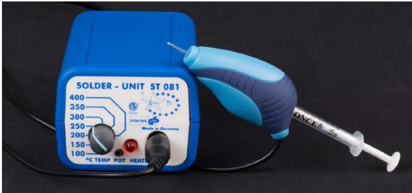
Aplikátor adheziva pro scelování trhlin metodou nit na nit. In: DEMUTH, Petra, FLOCK, Hannah 2019, s. 136.
